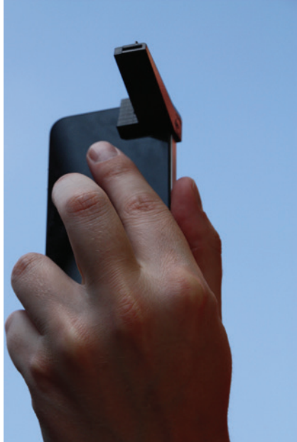
iPhone met opzetstuk voor fijnstofmeting.
